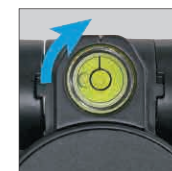
ストッパーを緩め、気泡が指示線の真上にくるように本体を回す。
